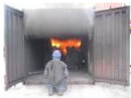
Die Temperatur in dem Container betrug über 500°C. Dies ist notwendig, damit überhaupt ein entsprechendes Luft/Gas-Gemisch entsteht, bei dem es ein Flashover geben kann. Es wurde aber auch der Hinweis gegeben, dass im Ernstfall die Temperatur viel höher sein wird. Die Brandlast in dem Container entsprach lediglich einem kleinen Sessel und enthielt keinerlei Kunststoffe.
